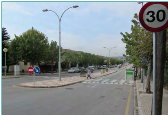
Imatge 26. Accés al carrer Arquitecte Falguera. Limitació de velocitat en vertical i horitzontal. Senyal de pas de vianants cobert per vegetació.
