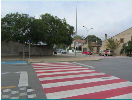
Imatge 54. Pas de vianants a la rambla del Sol amb reforç de pintura blanc i vermell.
