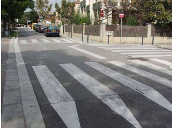
Imatge 38. Cruïlla elevada entre la rambla Mestre Pere Pou amb carrer Secretari Gil. Passos de vianants compactes i línia de detenció alineada amb el carril de circulació
