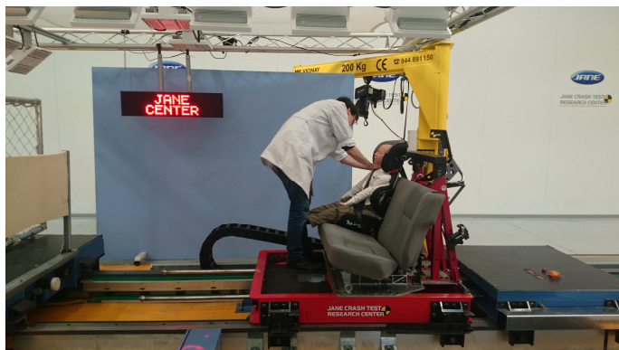
6. L'operari prepara els DUMIS a la zona de proves
