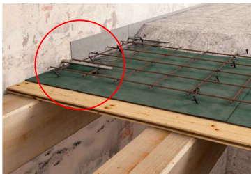
DETALL XAPA DE COMPRESSIÓ AMB ANCORATGES
