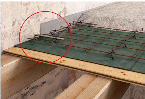
DETALL XAPA DE COMPRESSIÓ AMB ANCORATGES
