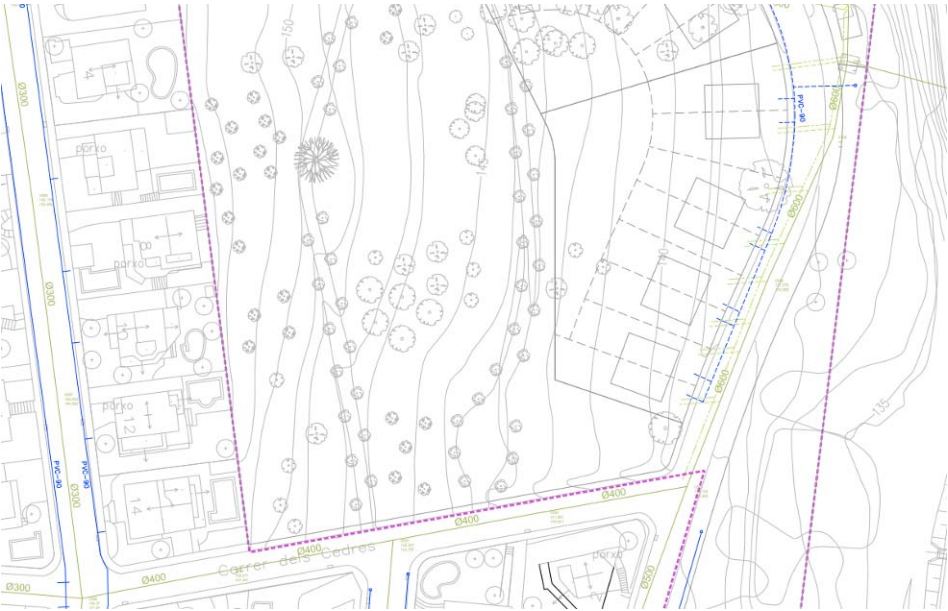
Ampliació xarxa de sanejament i subministra d'aigua Pau Carolina Salzes.
